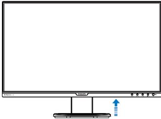
2. Coloque o monitor virado para baixo sobre uma superfície macia. Tenha cuidado para não riscar ou danificar o ecrã. Em seguida, levante a base do monitor.
