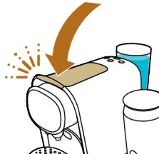
6 Coloque um recipiente com uma capacidade mínima de 1,5 litros no tabuleiro de recolha de pingos inferior sob o bico de distribuição do café para recolher a solução de descalcificação.
