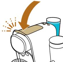
**6** Collocate un recipiente con una capacità di almeno 1,5 litri sul vassioio antigoccia inferiore sotto il beccuccio di erogazione del caffè per raccogliere la soluzione anticalcare.
