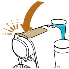
6 Plaats een kom met een inhoud van minstens 1,5 liter op de onderste lekbak, onder de koffie-uitloop, om de ontkalkingsoplossing op te vangen.
