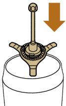
**10** Coloque a tampa do acessório para espuma de leite com o suporte do batedor novamente no acessório para espuma de leite.
