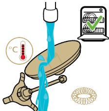
7 Skyll lokket på melkesummeren og vispholderdelene under glovarmt, rennende vann.
