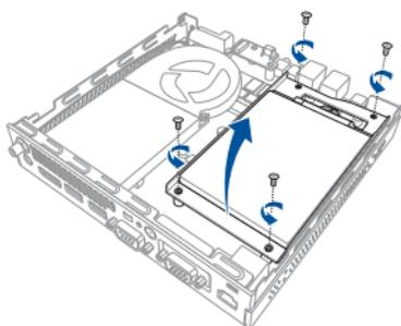
2. Inserite il vostro HDD o SSD nel supporto di archiviazione quindi fissatelo con quattro (4) viti.
