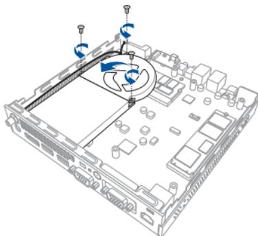
2. Allineate e inserite la scheda wireless nello slot all'interno del Mini PC quindi spingete delicatamente la scheda verso il basso dalla parte opposta, a questo punto fissatela usando una delle viti a testa rotonda da 3mm.
