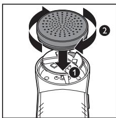
**11** Fissare e riavvitare in senso orario il coperchio sull'apparecchio.
