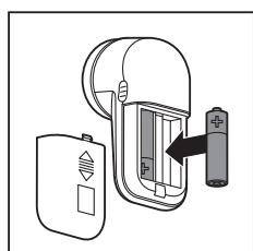
**1 ถอดฝาครอบแบตเตอรี่ออกแล้วใส่แบตเตอรี่อัลคาไลน์ขนาด AA 2 ก้อนตามข้อบวก (+) และข้อลบ (-)**
