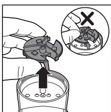
8 確保並未握住/碰到刀片。輕輕將刀片拉起並取下。
