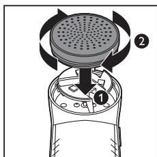
**11** Coloque novamente a tampa no aparelho, rodando-a para a direita.
