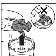
8 ตรวจสอบให้แน่ใจว่าคุณไม่ได้จับ/สับผ้าสีบัด ค่อยๆ ดึงใบมีดขึ้นมาอย่างระมัดระวังและถอดใบมีดออก
