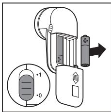
5 Чтобы выключить прибор, сдвиньте ползунок вниз. Извлеките щелочные батарейки.
