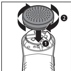
**11** Helyezze vissza, és az óramutató járásával megegyező irányba csavarozza vissza a fedelet a készülékre.
