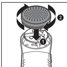
**11** Draai het dekseltje weer met de klok mee vast op het apparaat.
