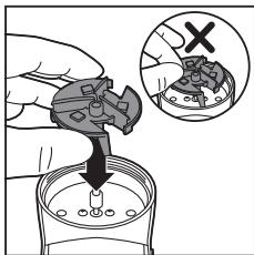
**10** Assicurarsi di non toccare le lame. Fissare le lame all'interno dell'apparecchio.
