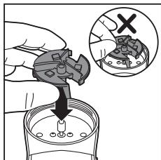
**10** Certifique-se de que não toca nas lâminas nem segura nelas. Coloque as lâminas no aparelho.
