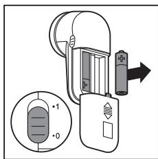
5 Khi cắt xong, hãy trượt nút trượt xuống dưới để tắt thiết bị. Tháo pin kiềm.
