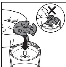
**10** Ujistěte se, že se nedotýkáte břitů. Znovu připevněte břity.
