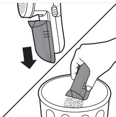
6 Снимите переднюю крышку, сдвинув ее вниз, и стряхните катышки в мусорную корзину.
