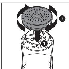
11 Załącz i przekręć pokrywę w prawo na urządzeniu.
