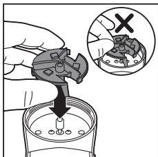
**10** Pazite da ne držite / ne dodirujete rezače. Pričvrstite rezače na aparat.
