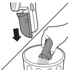
6 向下滑动前盖将其取下，将绒毛倒入垃圾桶中。
