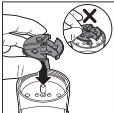
**10** Se till att du inte håller i eller vidrör bladen. Sätt tillbaka bladen i apparaten.
