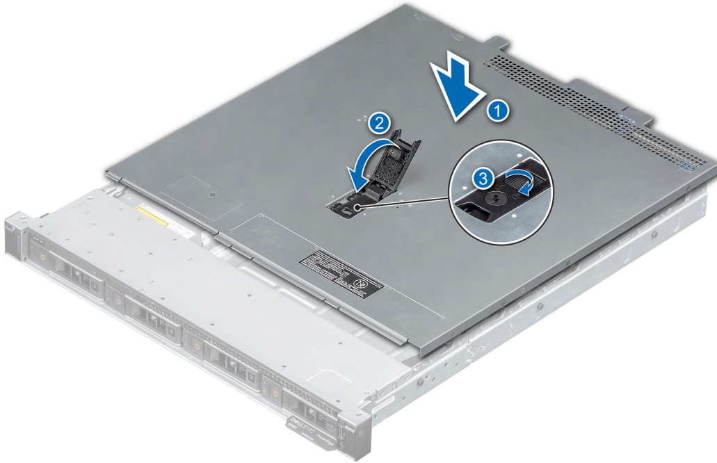
Abbildung 16. Installieren der Systemabdeckung
