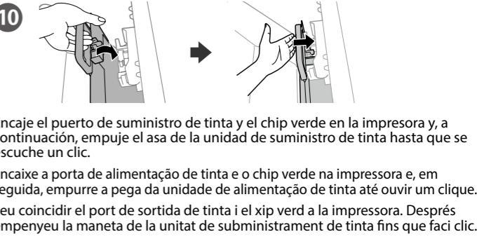
Encaje el puerto de suministro de tinta y el chip verde en la impresora y, a continuación, empuje el asa de la unidad de suministro de tinta hasta que se escuche un clic.
