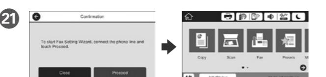
Cuando aparezca la pantalla del asistente para configuración de fax, toque proceder para definir la configuración mínima para las funciones de fax. Si no realiza la configuración ahora, cierre la pantalla de configuración de fax. Aparecerá la pantalla de inicio y la impresora estará preparada para imprimir.
