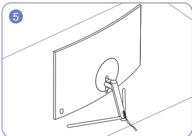
Verlegen Sie die angeschlossene Stromversorgung und das Datenkabel ordentlich und decken Sie dann die HINTERE NEBENABDECKUNG wie in der Figur gezeigt ab.
