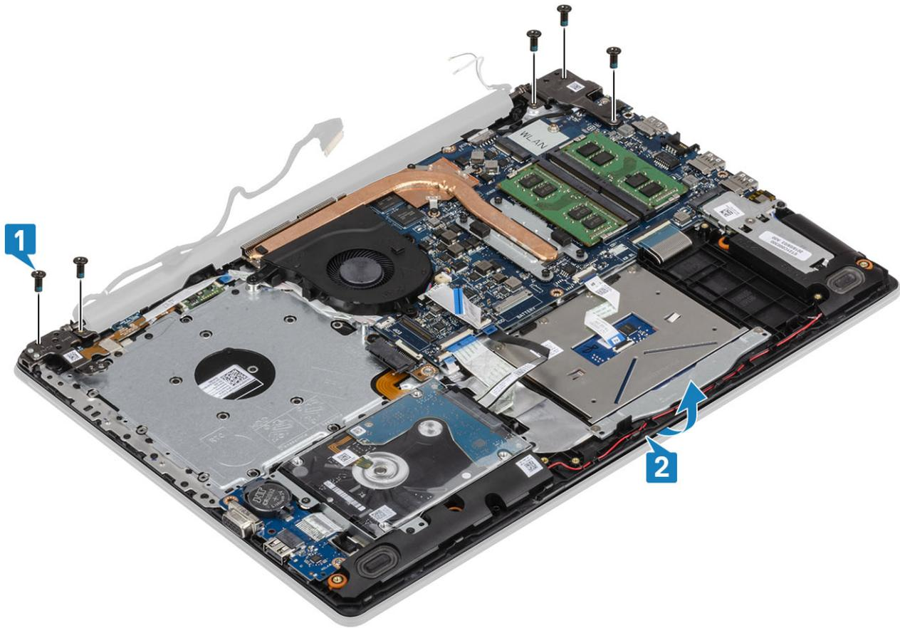
6 Levante las bisagras y extraiga el ensamblaje del teclado y reposamanos para extraerlo del ensamblaje de la pantalla [1, 2].
