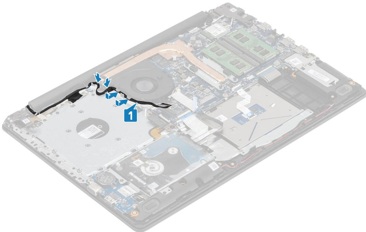
4 Conecte el cable del ventilador, el cable de la pantalla y el cable de la ODD a la tarjeta madre del sistema [1, 2, 3]
