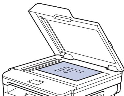
3. Posizionare l'angolo della pagina nell'angolo superiore sinistro del piano dello scanner.
