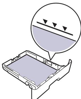
6. Spingere lentamente il vassoio carta per inserirlo completamente nella macchina.
