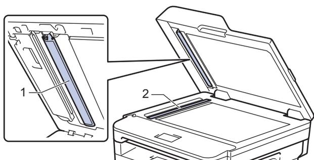
4. Aprire il coperchio del piano dello scanner (1) e pulire l'altra barra bianca (2) e la striscia del piano dello scanner (3) (solo per i modelli supportati).
