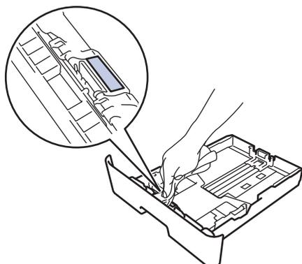
5. Pulire i due rulli di presa all'interno della macchina per rimuovere la polvere.
