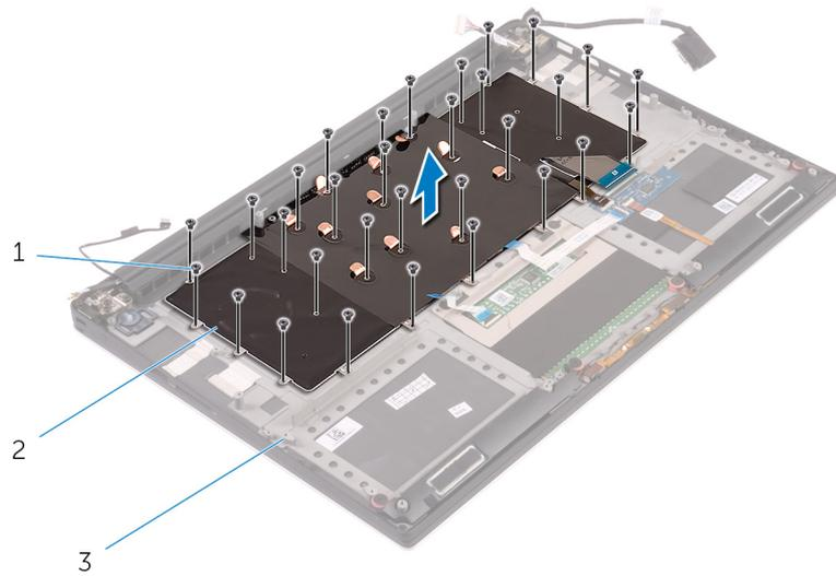
**Figure 28. Retrait des vis du clavier**
