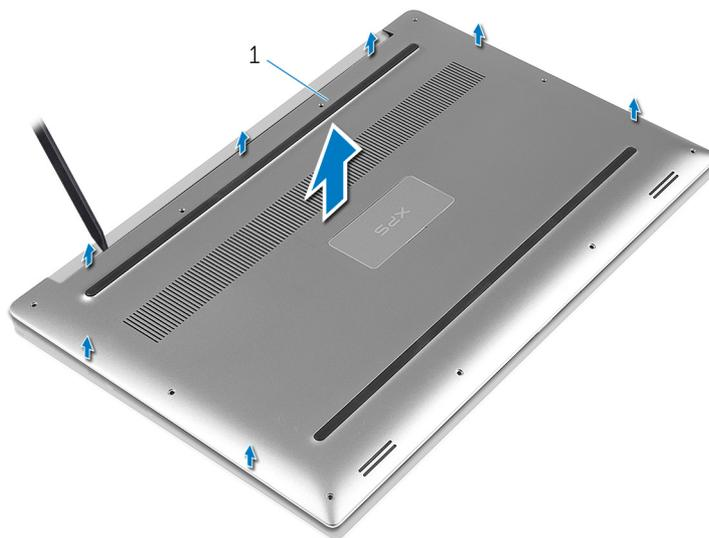
**Figure 2. Soulevez le cache de fond pour le retirer de la base de l'ordinateur**
