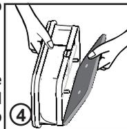
5. Rimontare i filtri e posizionare il coperchio supporto filtri nella corretta posizione indicata dalla freccia (posizione verso l'alto). Bloccare il coperchio con i ganci.
