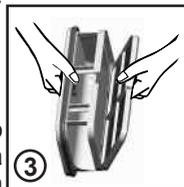
4. Rimuovere delicatamente il filtro a spugna dalla sede a lavarlo sotto acqua corrente per rimuovere residui o depositi.
