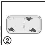
3. Rimuovere delicatamente il telaio agendo sul gancio superiore a pulire la rete filtrante da residui o depositi. Non usare acqua.
