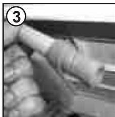
4. Fissare il raccordo nero del set (utilizzando il connettore e i ganci per tubi forniti) al raccordo rimosso dal collegamento a ponte.
