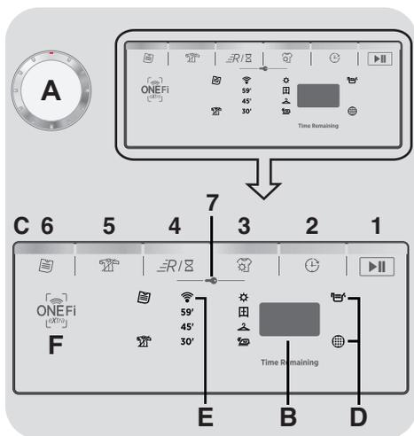
**A - Manopola** - Ruotando la manopola in entrambe le direzioni è possibile selezionare il programma di asciugatura desiderato. Per annullare il programma selezionato o spegnere l'asciugatrice, ruotare la manopola in posizione OFF.
