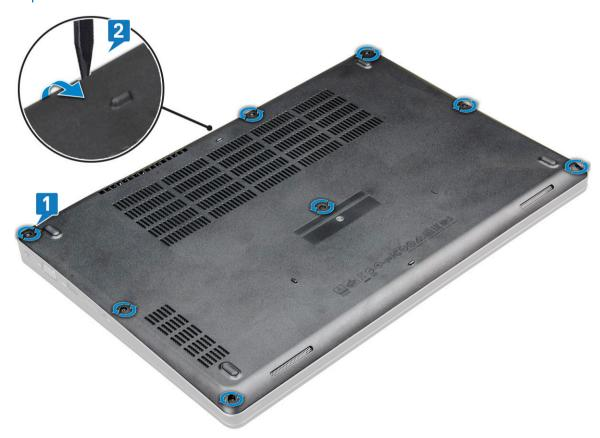
c Heben Sie die Bodenabdeckung vom System.
