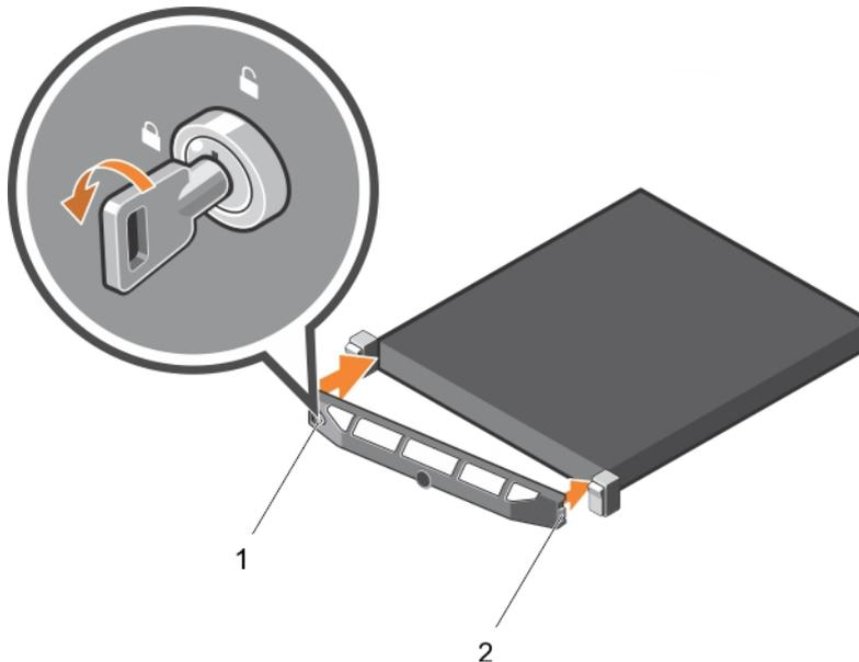
**Figure 12. Installing the optional front bezel**
