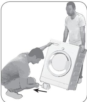
Um die Stabilisatoren zu entfernen;
