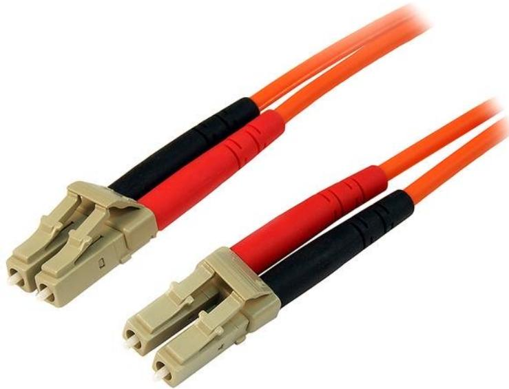
El cable de fibra óptica (3 m), categoría LSZH, LC a LC, modelo 50FIBLCLC3, con fibra óptica de 50/125 micrones para alta velocidad, proporciona transmisiones de datos a alto ancho de banda a través de redes Gigabit Ethernet y canal de fibra, con soporte para aplicaciones dúplex multimodo.
