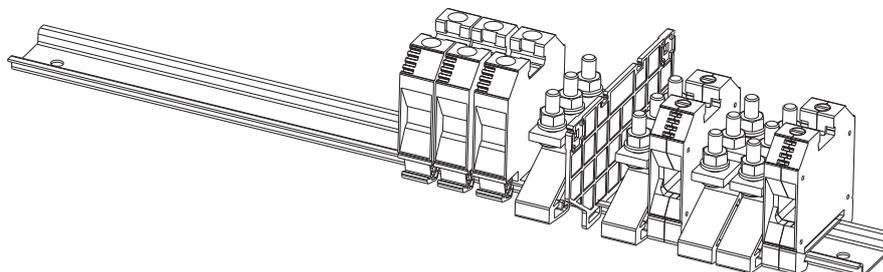
5. Remonter les bornes pour qu'elles adhèrent au séparateur fonctionnel isolant.
