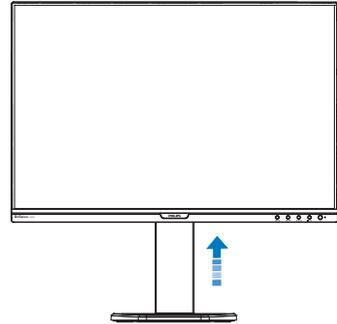
2. Coloque el monitor bocabajo sobre una superficie suave. Extrema la precaución para evitar arañar o dañar la pantalla. A continuación, levante el soporte del monitor.
