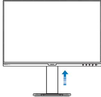
2. Coloque o monitor virado para baixo sobre uma superfície macia. Tenha cuidado para não riscar ou danificar o ecrã. Em seguida, levante a base do monitor.
