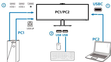
3. Accédez au menu OSD. Accédez à la section KVM et sélectionnez "Auto", "USB C" ou "USB amont" pour basculer le contrôle des périphériques d'un appareil à l'autre. Répétez simplement cette étape pour commuter le système de contrôle à l'aide d'un seul ensemble de périphériques.
