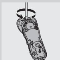
**6** С помощью отвертки отвинтите три винта на герметичном блоке питания на задней панели бритвы.
