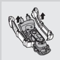
**4** Снимите боковые панели, сдвинув их с герметичного блока питания.
