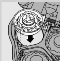
**4** Stare brivne glave odstranite iz brivne enote in jih nadomestite z novimi. Namestite nosilno ogrodje nazaj na brivno enoto in zavrtite zaklep proti desni.
