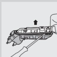
**7** С помощью отвертки снимите заднюю панель с герметичного блока питания.
