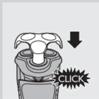
Для предотвращения повреждений бритвенных головок надевайте на электробритву защитный колпачок.
