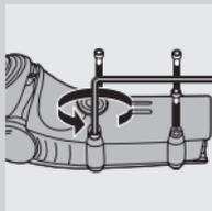
**2** Pozostaw golarkę włączoną, aż do wyczerpania się akumulatora. Używając śrubokrętu, odkręć śruby w komorze na zarost i wyjmij akumulator.
