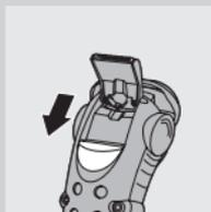
**1** Otwórz trymer, przesuwając suwak w dół. Trymer można otworzyć, gdy urządzenie jest włączone.
