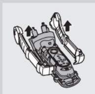
**4** Wyjmij boczne ścianki, odłączając je od szczelnego modułu zasilającego.
