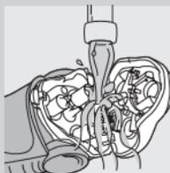
**3** Holiacu jednotku a komoru na chĺpky očistite opláchnutím pod prúdom horúcej vody.
