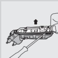
**7** Uklonite zadnju ploču zapečaćene jedinice za napajanje pomoću odvijača.
