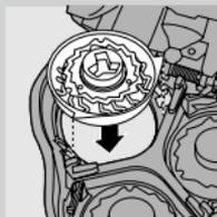
**3** Вставьте бритвенные головки в бритвенный блок. Установите крепёжную рамку в бритвенный блок и поверните фиксатор по часовой стрелке.
