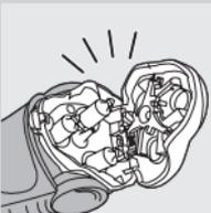
**5** Atkal atveriet skūšanas bloku un atstājiet to atvērtu, ļaujot ierīcei pilnīgi nožūt.
