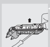
**8** 用螺丝刀将电源部件盖取下。
