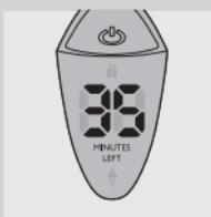
Sisa kapasitas baterai ditunjukkan apabila Anda menghidupkan atau mematikan alat cukur:
