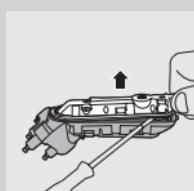
**8** 用螺丝刀将电源部件盖取下。
