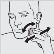
**2** 將電鬍刀刀頭在皮膚上移動，請同時用直線及畫圓的方式來移動。
