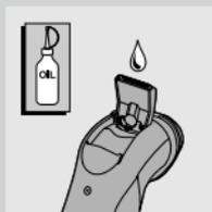
3 ทุกๆ หกเดือน ควรหยดน้ำมันจักรเพื่อหล่อลื่นซี่ฟันของที่กันจอน
