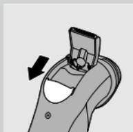
**1** 向下推动滑块，打开修发器。
