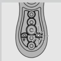
▶ 면도기를 청소할 때가 되면 수도꼭지 표시 위의 표시등이 매번 면도 후 깜박입니다(아래쪽 표시등이 적색으로 켜지는 경우 제외). 면도기를 정기적으로 청소하면 더 좋은 면도 효과를 얻을 수 있습니다. 일반적인 청소법은 면도기를 사용한 후에 항상 셰이빙유닛과 수염받이를 따뜻한 물로 헹구는 것입니다.
