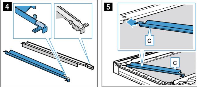
5. Reflektor **c** einsetzen (Bild 6).
