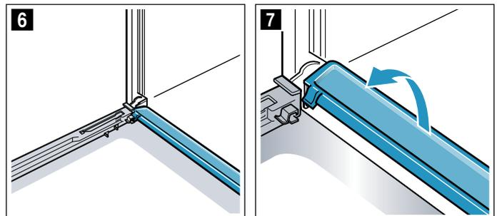
Reinigen Sie die Scheiben mit Glasreiniger und einem weichen Tuch. Wischen Sie die Kondensatleiste mit einem Tuch und heißer Spüllauge ab.
