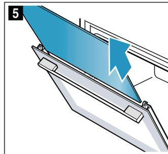
6. Bei Bedarf können Sie die Kondensatleiste zum Reinigen herausnehmen. Dazu die Gerätetür ganz aufklappen (Bild 6).
