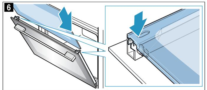
7. Abdeckung aufsetzen und andrücken bis sie hörbar einrastet (Bild 7).
