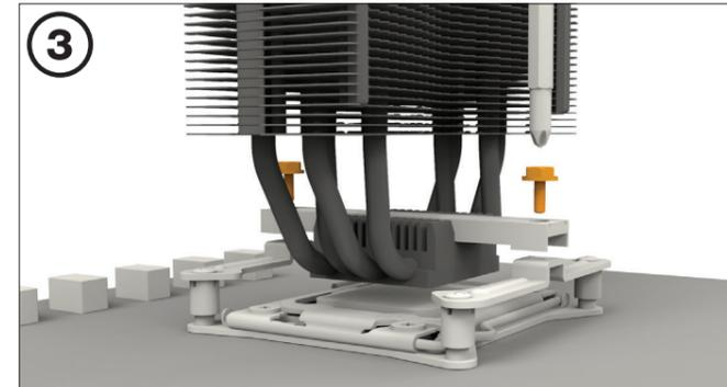
Positionnez le support de fixation du refroidisseur (6) au centre du ventirad. Ensuite, placez l'unité de refroidissement (1) sur le processeur. Insérer les vis de fixation du support de montage Intel / AMD (11) par le haut dans le support de montage du refroidisseur (6), puis vissez les alternativement. Vous pouvez utiliser n'importe quel tournevis cruciforme pour cela.
