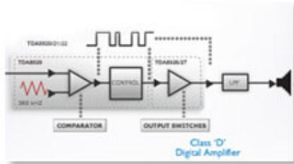
借助 2x50W RMS 音乐输出功率和“D”类数字功放器，让整个房间满溢您最爱的音乐。功放器接收模拟信号，将其转换成数字信号，然后将其放大出去。信号接着进入一个调制滤波器以形成最终的效果。放大的数字输出可提供数字音频的所有优点，包括音质提高。此外，D 类数字功放器与传统的 AB 功放器相比，效率高出 90%。这种高效率转换为一种强劲的功放器，而所占台面面积又很小。
