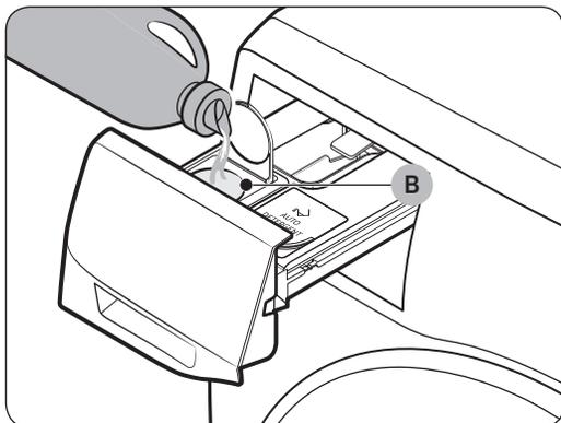
3. Füllen Sie gegebenenfalls eine geeignete Menge an Weichspüler in das **Weichspülerfach zur automatischen Dosierung (B)**.
