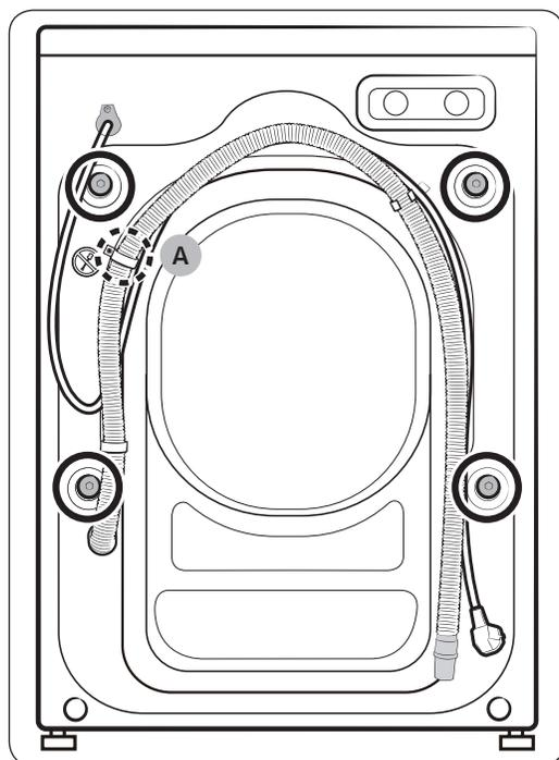
1. Suchen Sie die Transportsicherungen (in der Abbildung mit einem Kreis markiert) auf der Rückseite der Waschmaschine.
