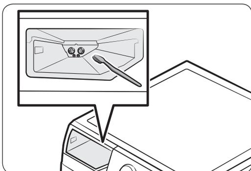
4. Reinigen Sie die Deckelventile der beiden Fächer mit einer weichen Bürste.
