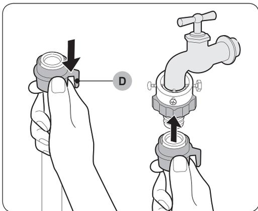
6. Ziehen Sie Teil (D) nach unten, und schieben Sie den Wasserschlauch auf den Adapter. Lassen Sie Teil (D) dann los. Der Schlauch rastet hörbar am Adapter ein.
