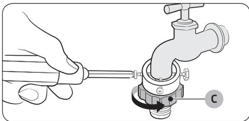
4. Schieben Sie den Adapter auf den Wasserhahn, ziehen Sie ihn hoch und befestigen Sie dann die Schrauben.
