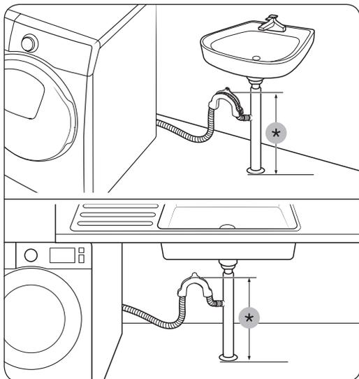
**Schlauch mit Anschluss am Abflussrohr verbinden**
