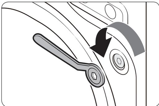
2. Lösen Sie mit dem mitgelieferten Schraubenschlüssel alle Transportschrauben durch Drehen gegen den Uhrzeigersinn.
