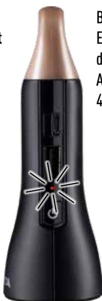
Beim Drücken der Ein/Aus-Taste **leuchtet** das rote Licht: Akkukapazität bei 40% - 25%.
