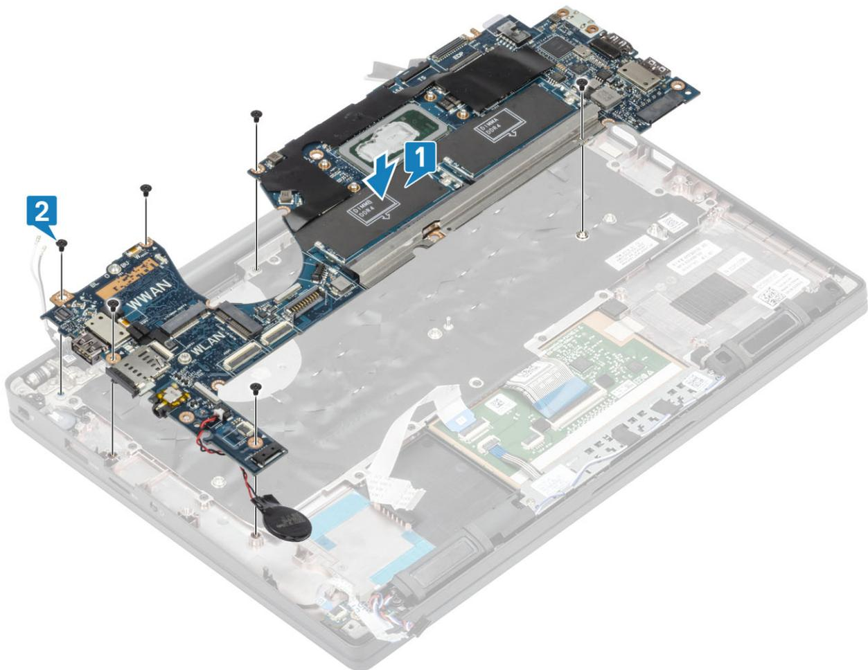
① **REMARQUE :** Sur les modèles équipés d'un lecteur d'empreintes digitales ou d'antennes WWAN, quatre vis (M2x3) maintiennent la carte système en place dans l'ordinateur.
