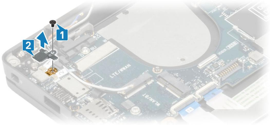
11 Débranchez les câbles d'antenne [1] et les câbles d'antenne WWAN et Darwin [2] de la carte système.
