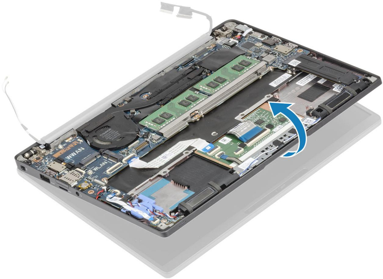
2 Retirez les six vis (M2,5x4) [1], puis l'assemblage d'écran de l'ensemble repose-mains [2].
