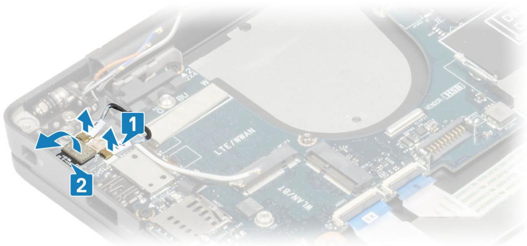
12 Retirez les deux vis (M2x4) [1] et retirez le support USB de type C de la carte système [4] en le soulevant.
