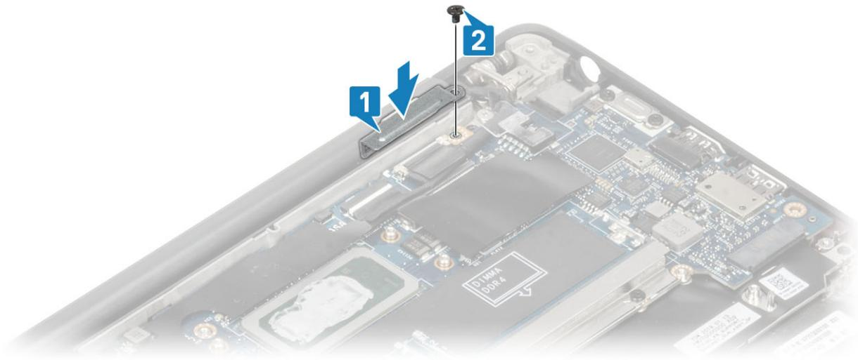
8 Installez le guide d'acheminement en caoutchouc sur la pile bouton.
