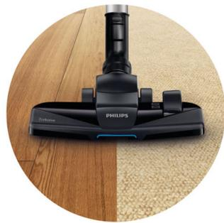
Die TriActive-Düse führt drei Reinigungsschritte in einem Arbeitsgang aus: 1) Sie raup mit der speziell entworfenen Unterseite den Teppich schonend auf, um tiefliegenden Staub aufzunehmen. 2) Sie nimmt große Teile über ihre größere Öffnung an der Vorderseite auf. 3) Sie nimmt Staub und Schmutz längsseits von Möbeln und Wänden über ihre zwei Luftkanäle auf der rechten und linken Seite auf.
