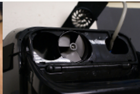
7.2 Reinigen Sie das Laufrad. 7.3 Das Schutzgitter einsetzen.
