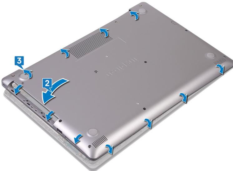
4 Reemplace los seis tornillos (M2.5x7) que fijan la cubierta de la base al ensamblaje del teclado y el reposamanos.
