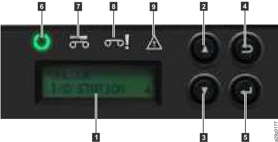
Figura 8. Componentes del Panel de operador
