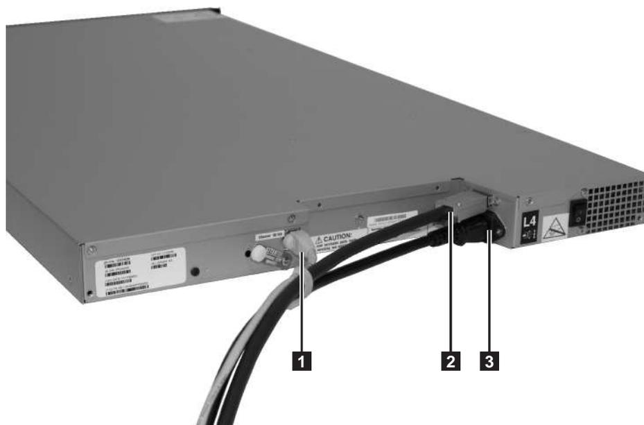
Figura 27. Conexión del cable de interfaz
