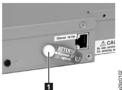
Figura 26. tornillo de bloqueo del descriptor de acceso
