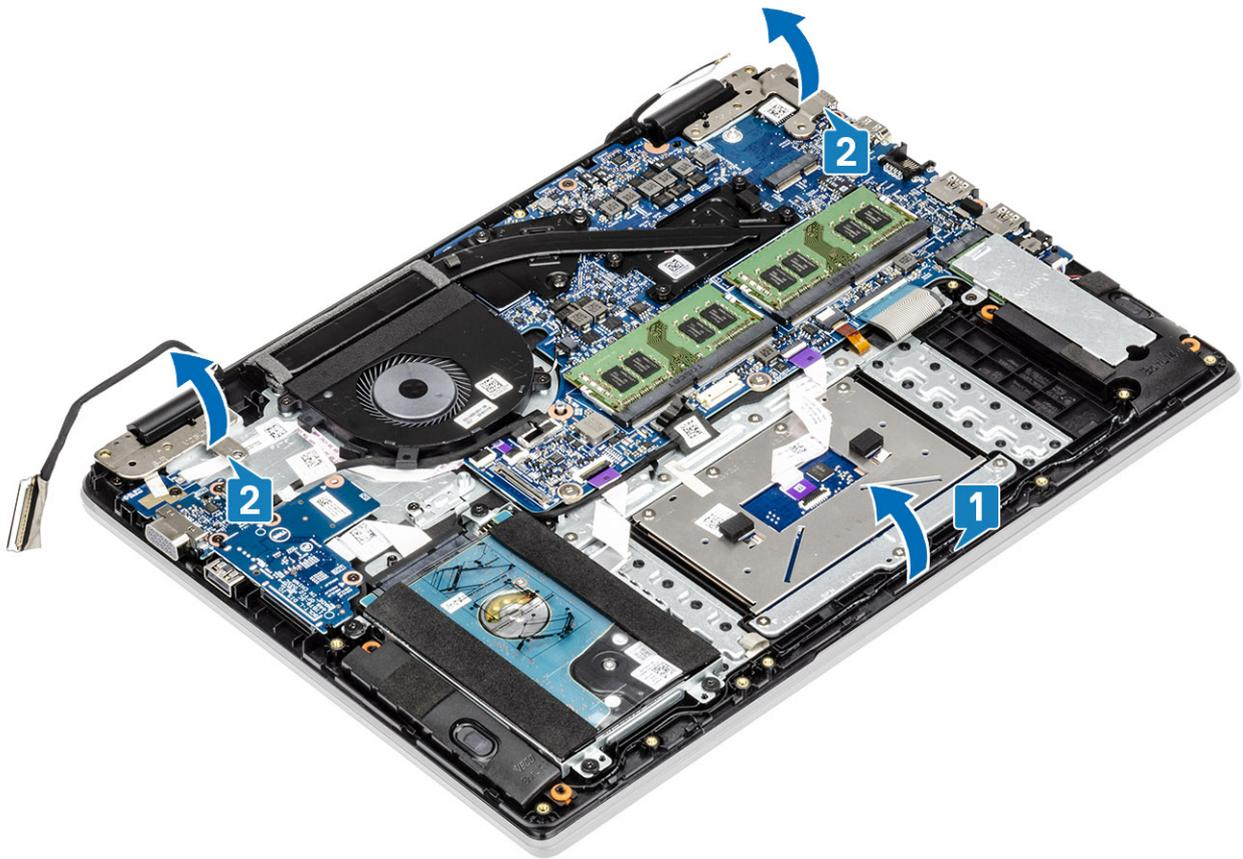
7 Deslice y quite el ensamblaje del teclado y el reposamanos del ensamblaje de la pantalla.
