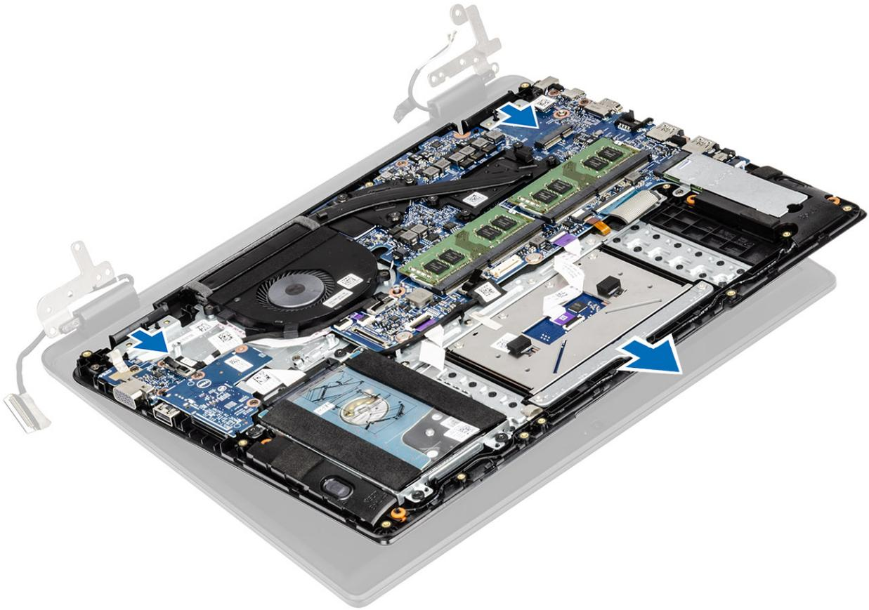
8 Después de realizar todos los pasos anteriores, queda el ensamblaje de la pantalla.
