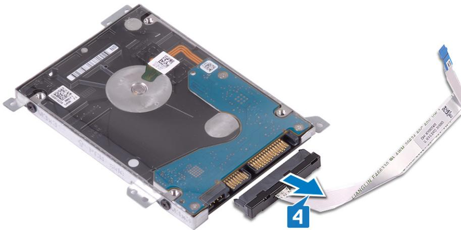
5 Retirez les quatre vis (M3 x 3) qui fixent le support du disque dur à ce dernier.
