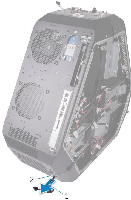
**Figure 77. Retrait des câbles de l'éclairage inférieur**
