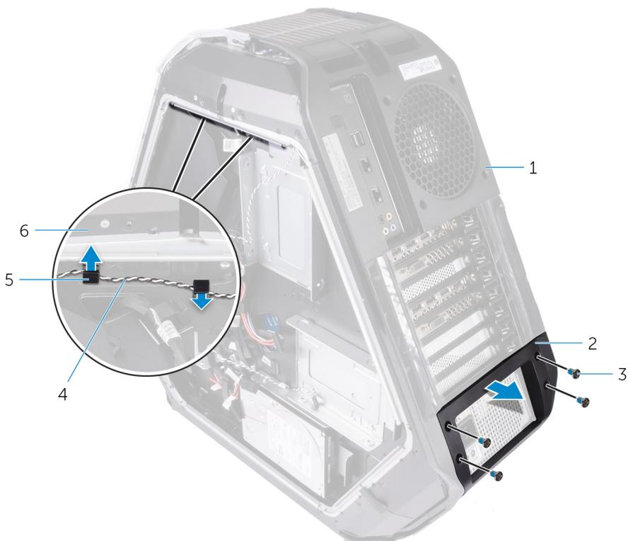
**Figure 66. Retrait du câble d'éclairage des E/S arrière**
