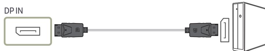
— Si consiglia un cavo DP con lunghezza inferiore a 1,5 m. L'utilizzo di un cavo lungo più di 1,5 m può compromettere la qualità delle immagini.
