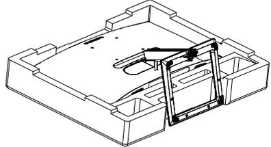
2. Lösen Sie die Schraube an der Unterseite der Basis mit einem Schraubendreher fest; entfernen sie die Basis vom Ständer.
