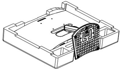
2. (1) Lösen Sie die Schraube an der Unterseite der Basis mit einem Schraubendreher.
