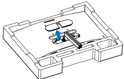
4. Entfernen Sie die Schrauben am Arm mit einem Schraubendreher und lösen Sie den Arm/Ständer vom Monitor.
