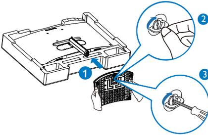
3. Richten Sie den Monitor nach Anbringung der Basis auf, indem Sie ihn mit beiden Händen sicher gemeinsam mit dem Styropor greifen. Nun können Sie das Styropor herausziehen. Beachten Sie, dass dieser Monitor ein gewölbtes Design besitzt. Drücken Sie den Bildschirm beim Herausziehen des Styropors nicht zusammen. Andernfalls könnte er beschädigt werden.
