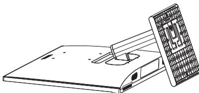
2. (1) Utilize uma chave de fendas para desapertar o parafuso localizado na parte inferior da base.
