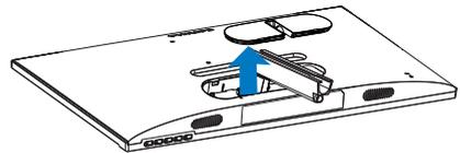
4. Utilize uma chave de fendas para remover os parafusos da coluna e desencaixe a coluna/suporte do monitor.
