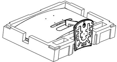
2. (1) Utilice el destornillador para aflojar el tornillo ubicado debajo de la base.
