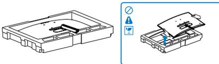
2. (1) Sujete el soporte de la base con ambas manos e inserte firmemente el soporte de la base en la columna de la misma.
