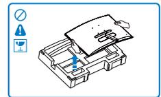
2. (1) Sujete el soporte de la base con ambas manos e inserte firmemente el soporte de la base en la columna de la misma.
