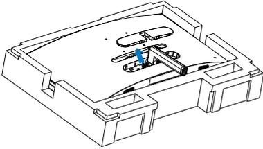
4. Utilice un destornillador para quitar los tornillos del brazo y, a continuación, desmonte el brazo y el pie del monitor.
