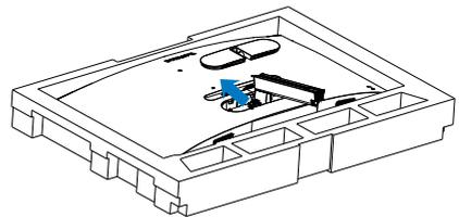
4. Utilice un destornillador para quitar los tornillos del brazo y, a continuación, desmonte el brazo y el pie del monitor.
