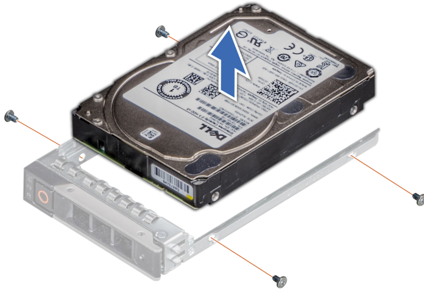
Figure 53. Retrait d'un disque dur installé de son support
