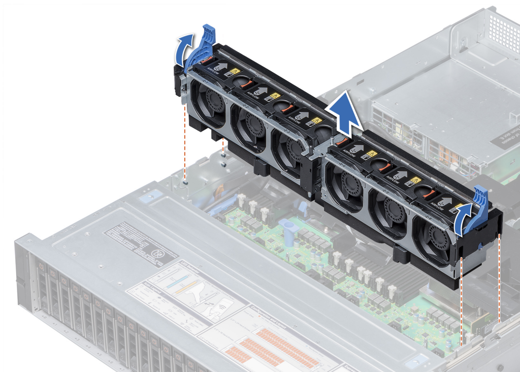
Figure 33. Retrait de l'assemblage de ventilation
