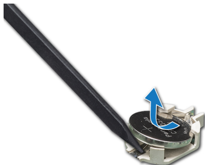
Figure 120. Retrait de la pile du système
