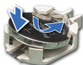
Figure 121. Installation de la pile du système
