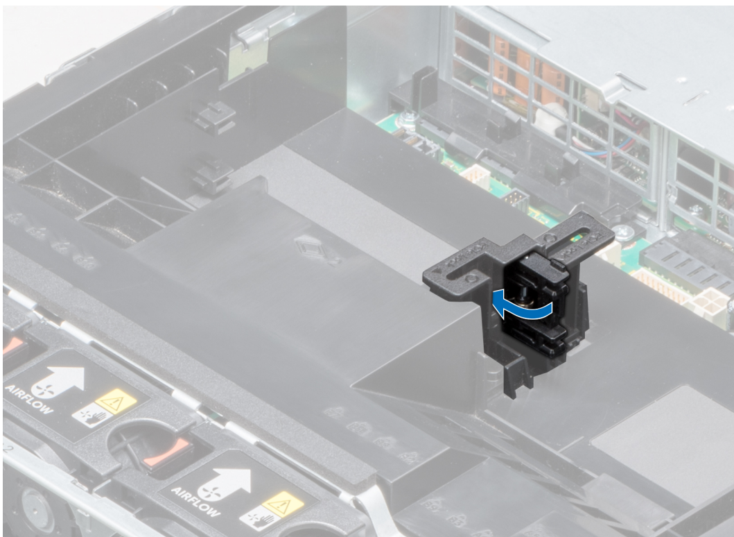
Figure 65. Fermeture du loquet du support de carte PCIe
