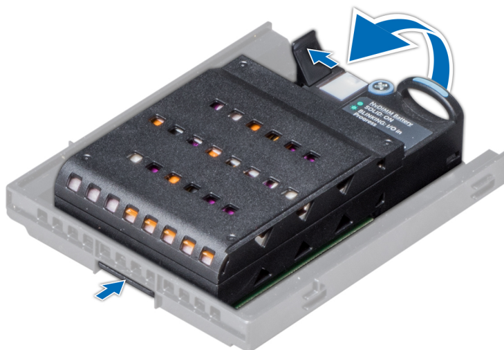
Ilustración 43. Extracción de la batería NVDIMM-N del soporte
