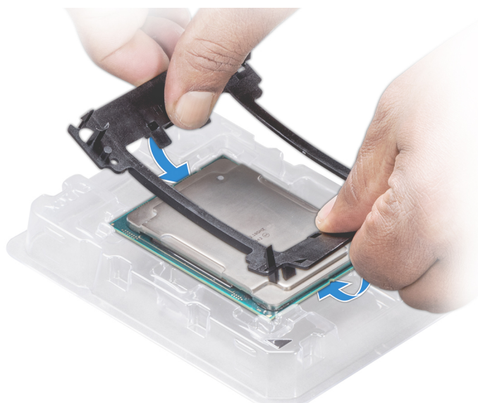
Ilustración 60. Instalación del soporte del procesador
