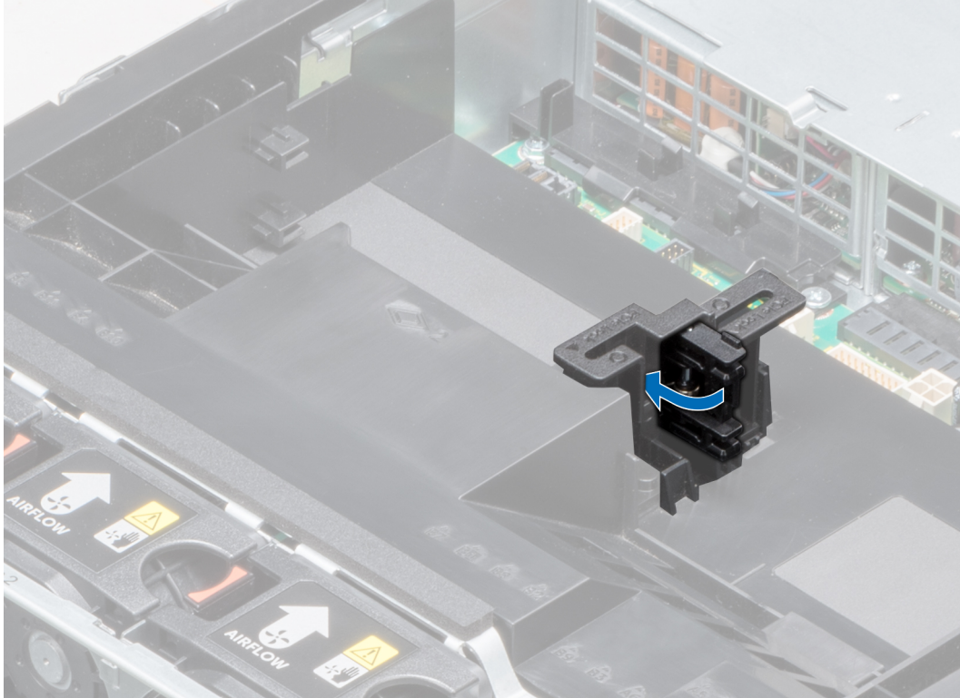
Ilustración 65. Cierre del pestillo del soporte de tarjeta PCIe
