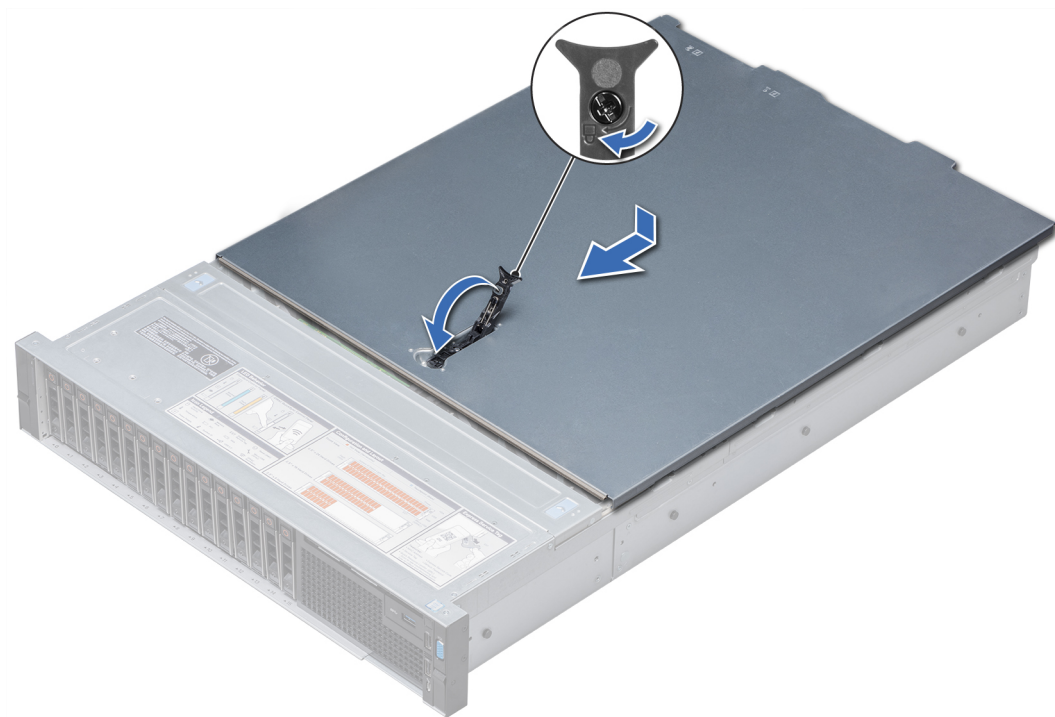
Ilustración 26. Instalación de la cubierta del sistema
