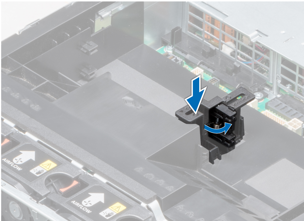
Ilustración 64. Cómo abrir el pestillo del soporte de tarjeta PCIe
