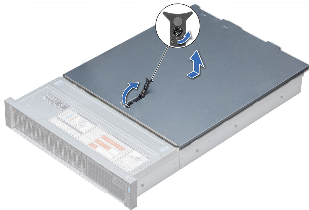
Ilustración 25. Extracción de la cubierta del sistema
