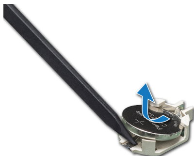
Ilustración 120. Extracción de la batería del sistema
