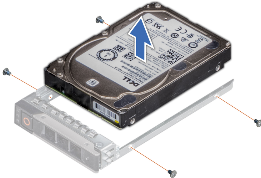
Ilustración 53. Extracción de una unidad del portaunidades
