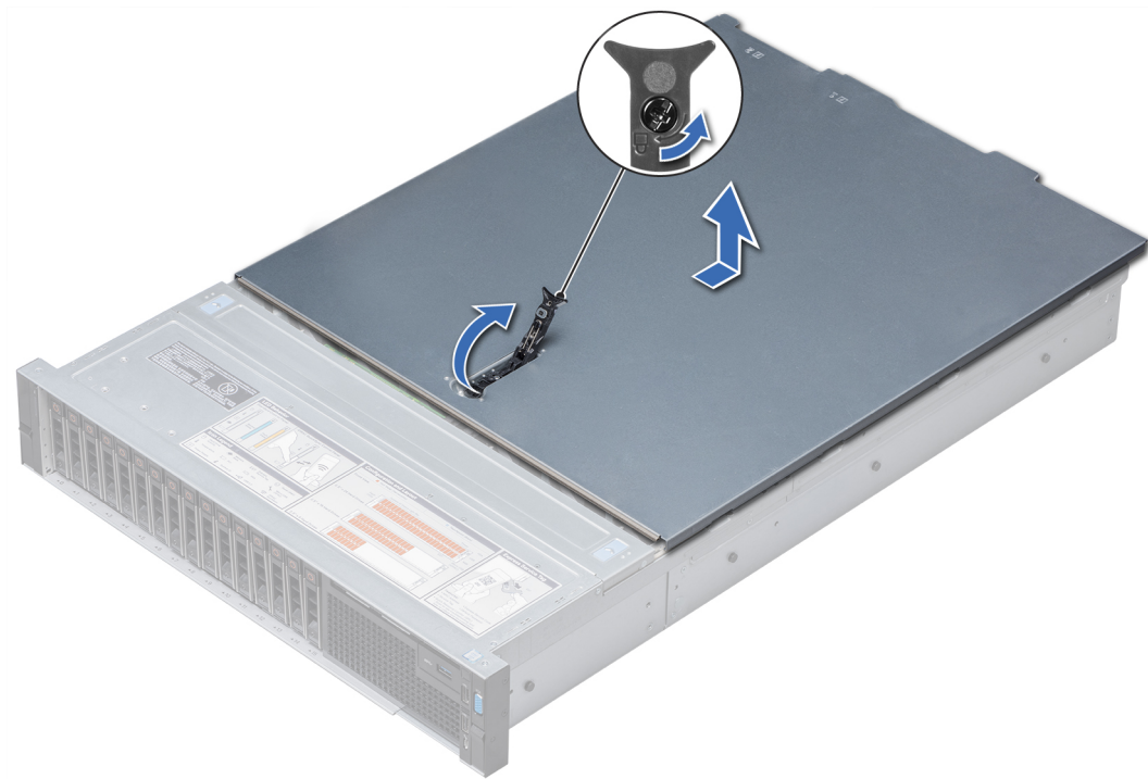
Abbildung 25. Entfernen der Systemabdeckung
