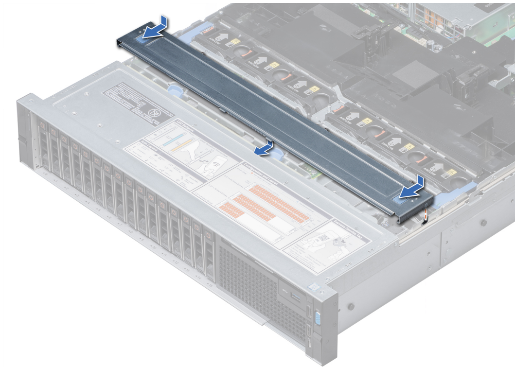
Abbildung 28. Anbringen der Rückwandplattenabdeckung
