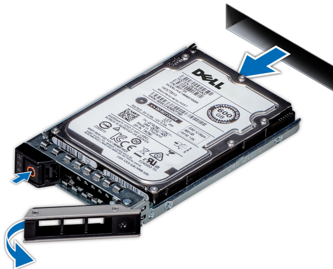
Abbildung 47. Entfernen eines Festplattenträgers
