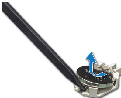
Abbildung 120. Entfernen der Systembatterie
