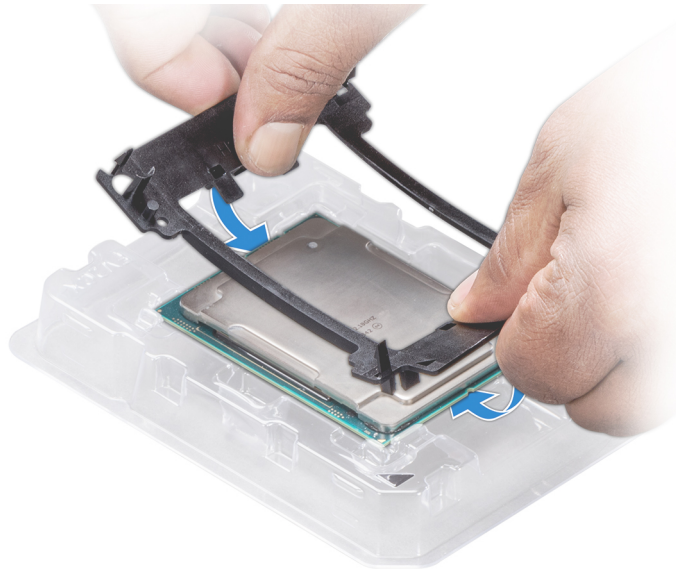
Abbildung 60. Installieren der Prozessor-Halterung
