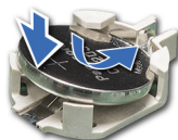
Abbildung 121. Installieren der Systembatterie
