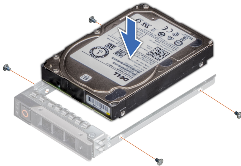
Abbildung 54. Einsetzen eines Laufwerks in den Laufwerkträger
