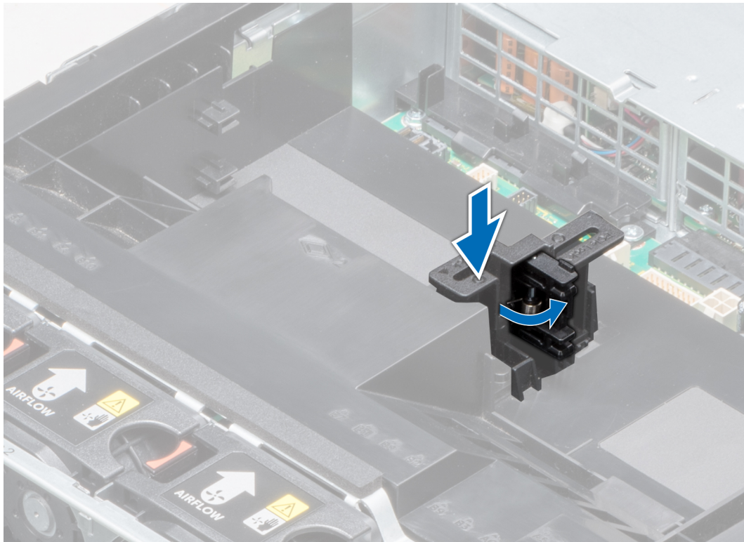
Figura 65. Cómo abrir el pestillo del soporte de tarjeta PCIe
