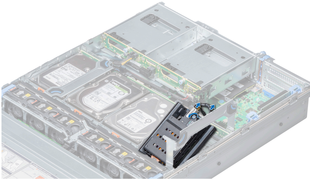
Figura 42. Extracción de la batería NVDIMM-N de la bandeja de unidad intermedia
