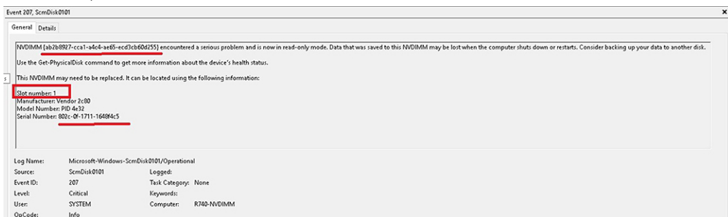
Figure 22. Informations de journalisation des opérations et des diagnostics : disque NVDIMM-N
