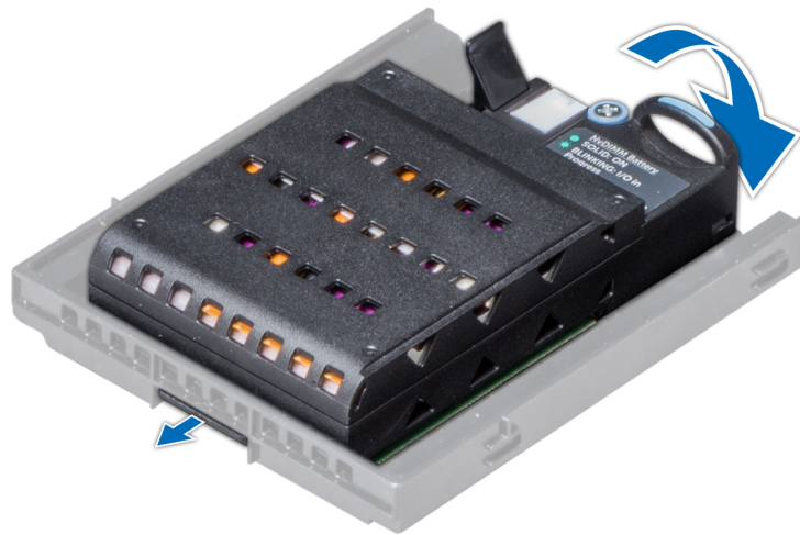
Abbildung 45. Einsetzen des NVDIMM-N-Akkus in die Halterung
