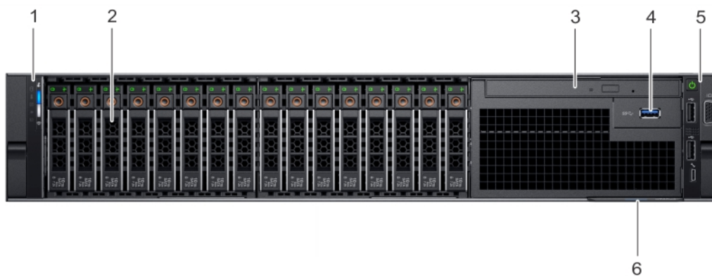
Abbildung 2. Vorderansicht eines Systems mit 16 x 2,5-Zoll-Laufwerkssystemen
