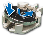
Abbildung 122. Installieren der Systembatterie
