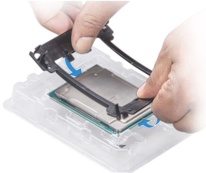
Abbildung 61. Installieren der Prozessor-Halterung
