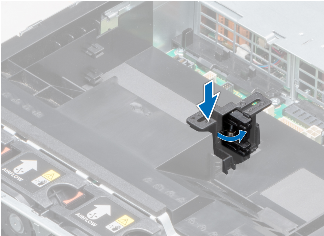
Abbildung 65. Öffnen des PCIe-Kartenhalterverriegelung
