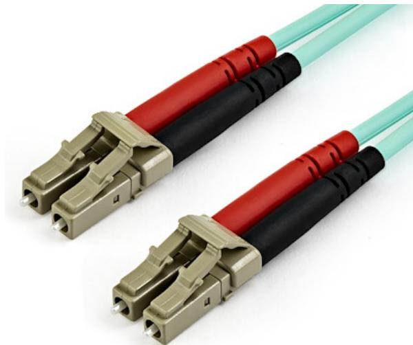
Este cable de parcheo de fibra óptica dúplex OM3 LC a LC multimodo cuenta con fibra de 50/125 micras y admite la transmisión de datos de gran ancho de banda a través de una conexión Ethernet de 10 Gigabits.
