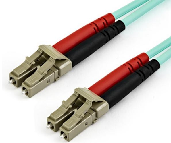
Este cable de conexión de fibra óptica dúplex OM3 LC a LC multimodo presenta fibra de 50/125 micras y admite la transmisión de datos de gran ancho de banda a través de una conexión Ethernet de 10 Gigabits.
